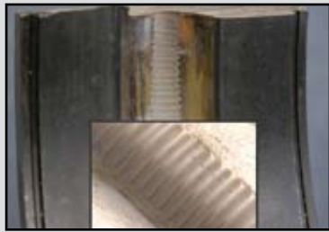
電食によるベアリング・レース面のフルーティング（洗濯板状のパターン）
